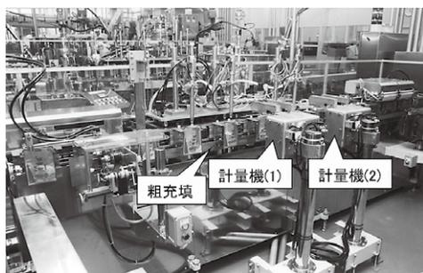
写真1 容量式と質量式を組み合わせたハイブリッド方式の（無人化）液体包装ライン（事例：2002年）
