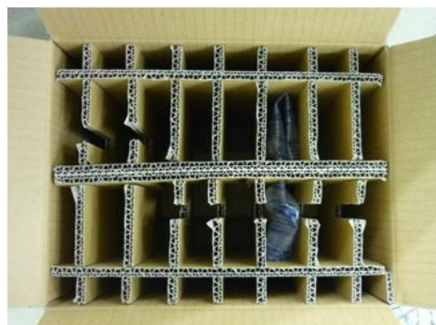
オールダンボールにて包装 包装コスト、輸送費=1/3化 産廃物“0”化
